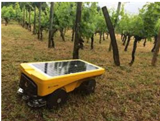
Vitrover / prototype de robot autonome qui tond dans les vignes. (Crédits photo : Vitrover)
