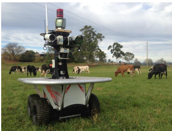
Figure 21 : Démonstrateur d'un robot berger développé en Australie
